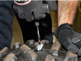
6. Cut off the excess PermaCure on the outside of the tire. Corte el exceso de PermaCure en el exterior del neumático.
